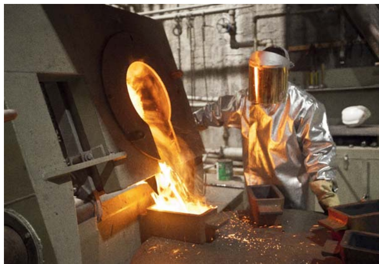
Разливка золота на слитки на руднике «Купол»
