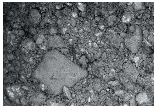
Рис. 3. Закладочная смесь по рецептуре, кг/м 3 : Ш = 600, Х = 800, Ц = 170 (проявлены межзеренные контакты)
