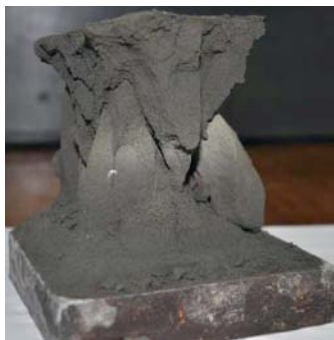
Рис. 2. Характерный вид полуразрушенного образца состава ШХЦ
