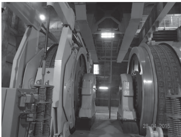
Рис. 2. Скиповые подъемные машины в копре СКС
