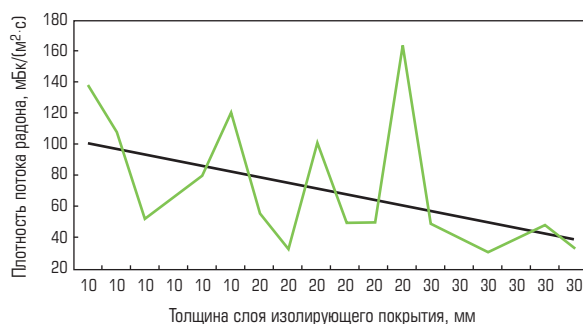
Рис. 3. Диаграмма изменения плотности потока радона образцов пасты с изолирующим покрытием из серобетона при толщине слоя 10, 20, 30 мм
