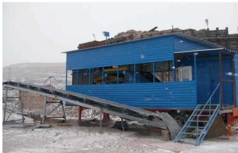
**Рис. 3. Передвижной узел рентгенометрической сепарации на базе сепаратора СРФ4-150**
