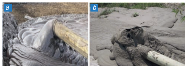
Рис. 1. Транспортирование пасты по трубопроводу:
