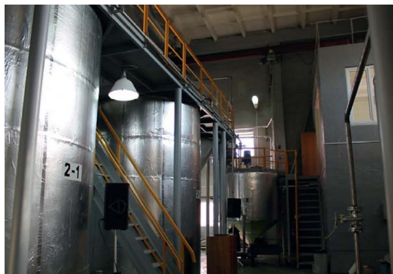
Емкости для приготовления десорбирующего раствора на опытно-промышленной установке
