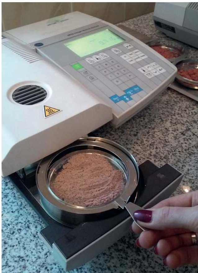
Определение влаги образца на анализаторе влажности HR-73
