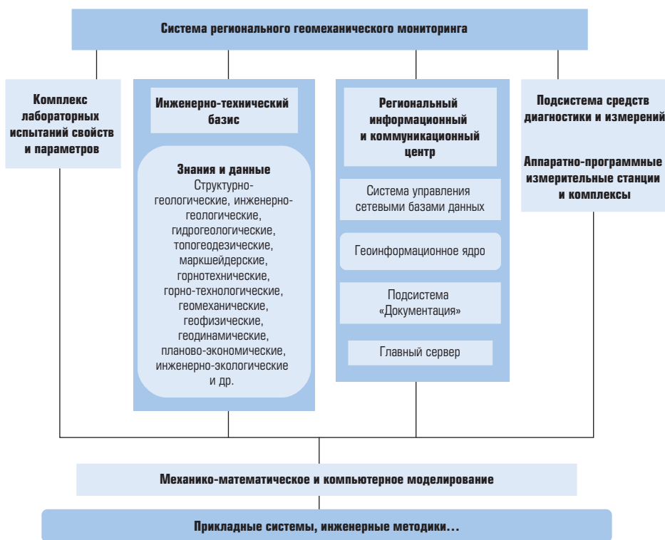
Рис. 1. Общая структура системы регионального геомеханического мониторинга
