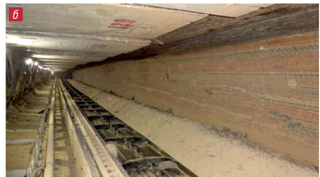
Рис. 4. Внешний вид монтажного штрека после расширения и установки анкерной крепи (а) и забоя лавы (б) № 11-3 гор. -620 м рудника Третьего РУ
