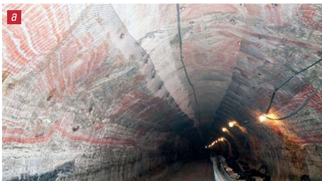
Рис. 4. Внешний вид монтажного штрека после расширения и установки анкерной крепи (а) и забоя лавы (б) № 11-3 гор. -620 м рудника Третьего РУ
