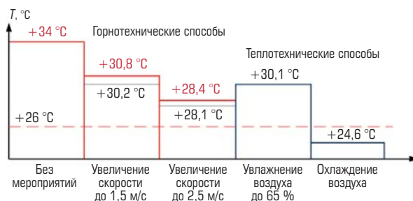
Рис. 3. Эффективность различных способов регулирования теплового режима (красным цветом обозначены результаты экспериментальных измерений)
