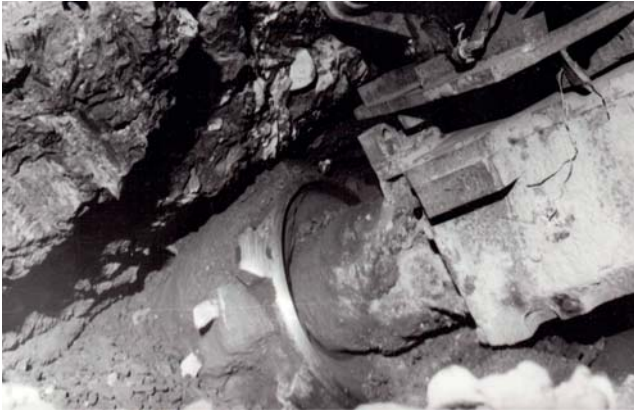
Рис. 1. Проходка вруба по плотнику режущей коронкой комбайна
