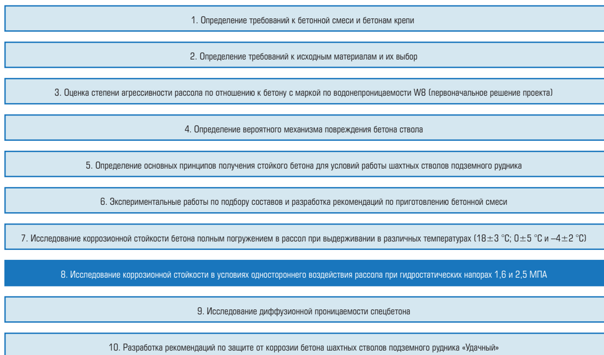
Рис. 1. Этапы работ по разработке составов специальных бетонов для возведения шахтных стволов подземного рудника «Удачный»
