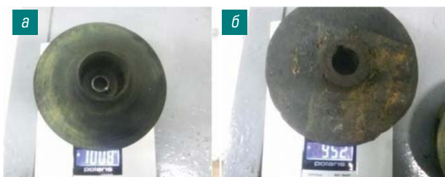
Рис. 2. Рабочие колеса насоса К8/18: а — новое; б — изношенное
