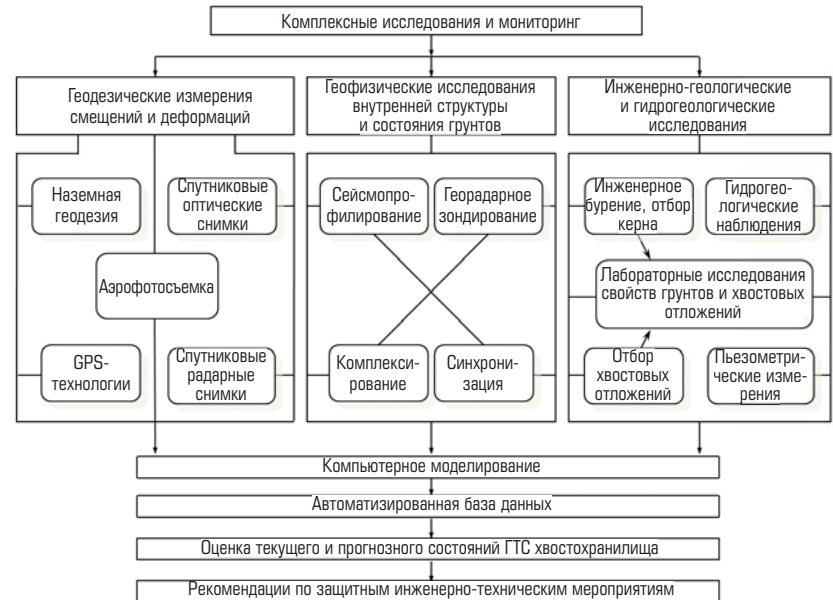
Рис. 1. Структура комплексных исследований и мониторинга хвостохранилищ горнопромышленных предприятий
