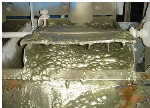
Рис. 2. Благороднометаллический сульфидный концентрат из малосульфидных руд месторождения Федорова Тундра
