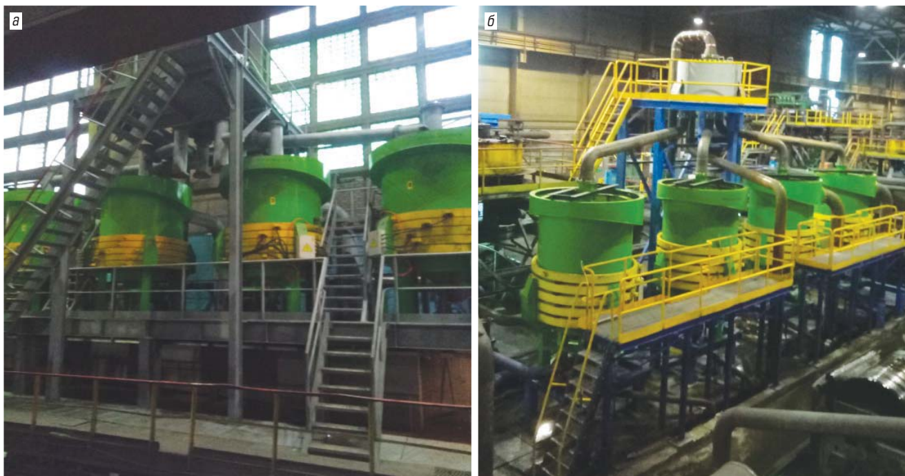
Рис. 3. Получение ВКК с использованием сепараторов МГС-2.0 на АО «Олкон» (а) и АО «Карельский окатыш» (б)
