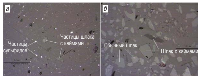
Рис. 1. Микрофотографии аншлифов флотоконцентрата (а) и хвостов флотации (б)
