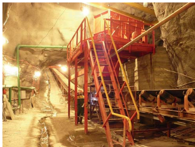
Дробильно-конвейерный комплекс циклично-поточной технологии добычи руды на Расвумчоррском руднике
