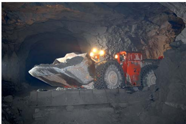
Погрузочно-доставочная машина на выпуске и доставке руды в блоковый рудоспуск
