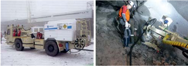
Рис. 1. Смесительно-зарядная машина MSU для зарядания восходящих скважин
