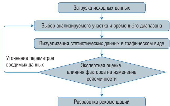
Рис. 3. Структура программного обеспечения Seasonal Seismic Activity Identification System (AS SSAIS) для автоматизированной обработки данных, анализа и прогноза сейсмической активности
