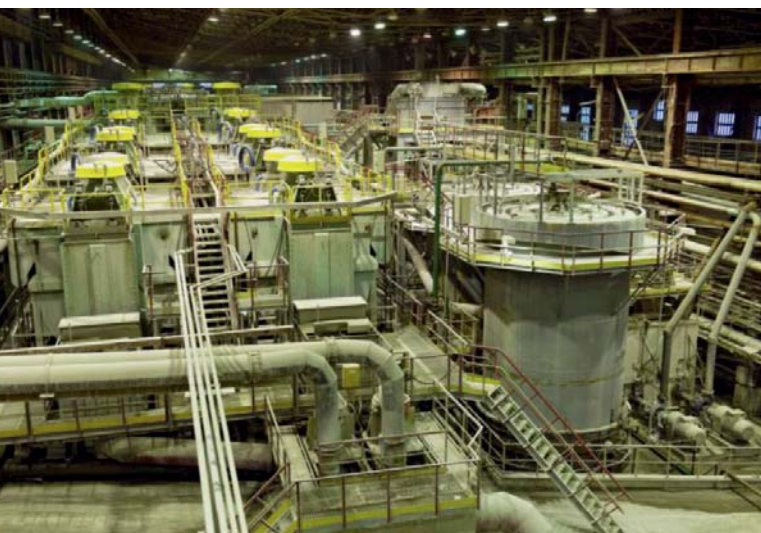
Рис. 2. Современное флотационное оборудование АНОФ-2 (с 2008 г.) — флотокамеры ОК-38 и колонные флотомашины
