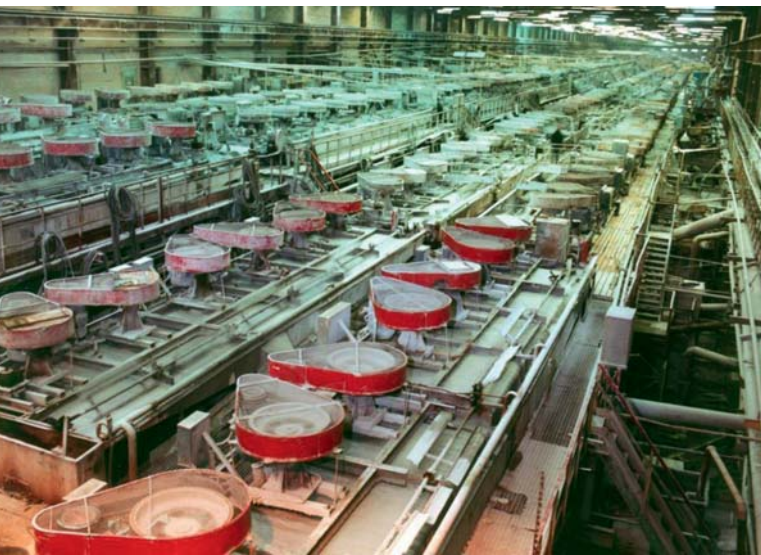
Рис. 1. Механические флотомашины ФМР-6,3 на АНОФ-2 (до 2010 г.)
