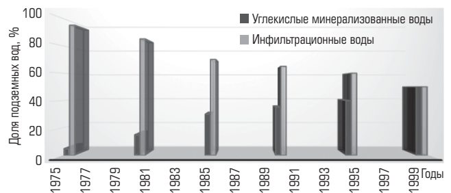
Рис. 2. Вклад подземных вод нижней и верхней гидрогеологических зон в общее обводнение рудника «Молибден»
