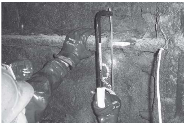
Рис. 3. Распил ребра тьюбинга на глубину 11 мм для определения фактических напряжений
