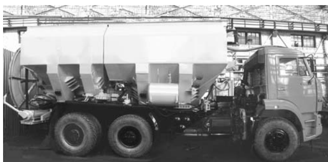
Рис. 4. Смесительно-зарядная машина МЗУ-16
