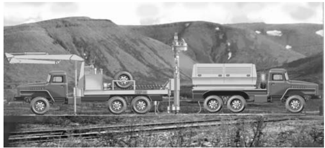
Рис. 4. Буровая установка СБУ-360
