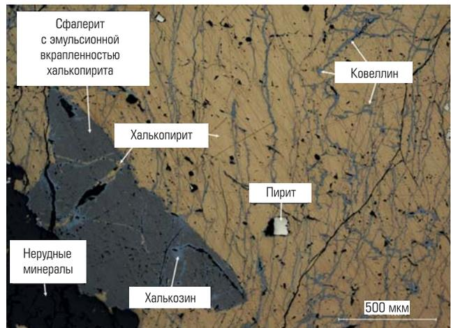
**Рис. 4. Коррозионные структуры: халькопирит развивается по трещинам в сфалерите и замещается вторичными минералами меди — халькозином и ковеллином. Отраженный свет, николи параллельны**
