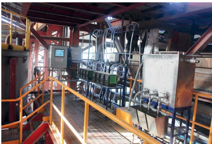
Автоматизированная установка дозирования реагентов УДР-РИФ на обогатительной фабрике предприятия Carmen Copper Corporation
