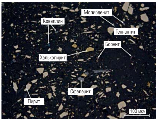
Рис. 14. Концентрат шламовой фракции. Отраженный свет, николи параллельны. Темные зерна с рельефом — нерудные минералы
