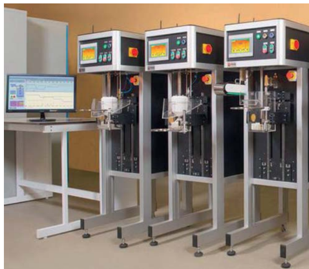
Рис. 2. Автоматизированная система технолога-исследователя АСУ ТИ на базе лабораторных флотомашин ФМЛ-30
