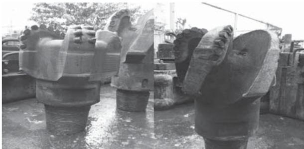
**Рис. 1. Долота PDC с отрицательным углом установки резцов**
