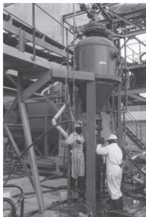
Испытания гидроподъемного аппарата на шахте в ЮАР
