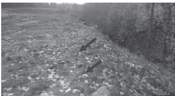
**Рис. 1. Трещины закола на бровке откоса отвала**
