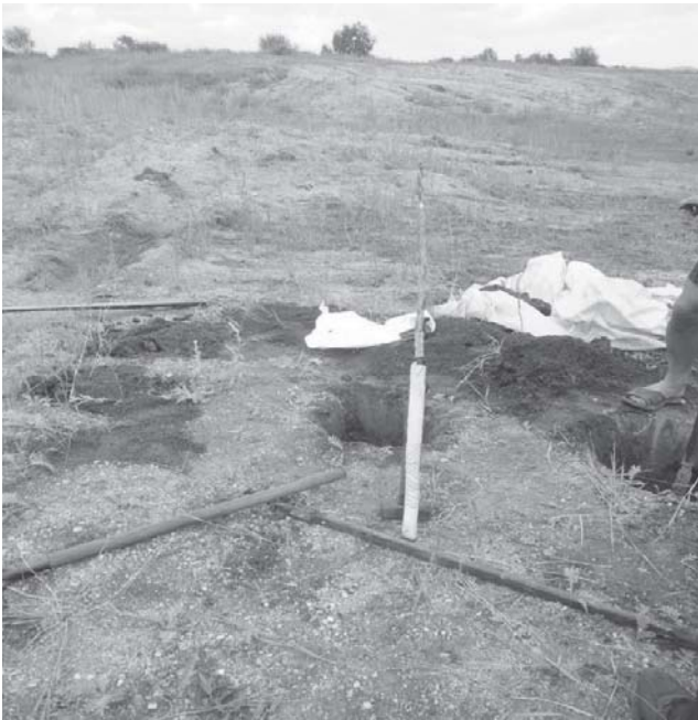
Рис. 3. Внутрискважинный медный катод с оболочкой из ионообменной смолы
