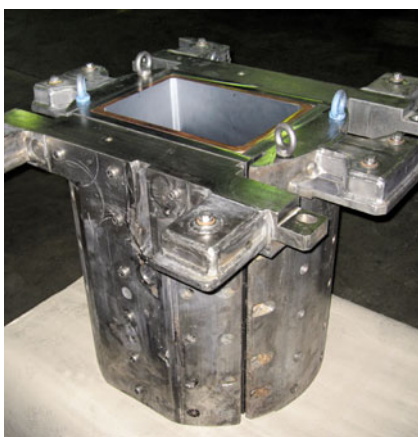
Рис. 3. Интегрированный кристаллизатор в сборе с водоохлаждаемой рубашкой
