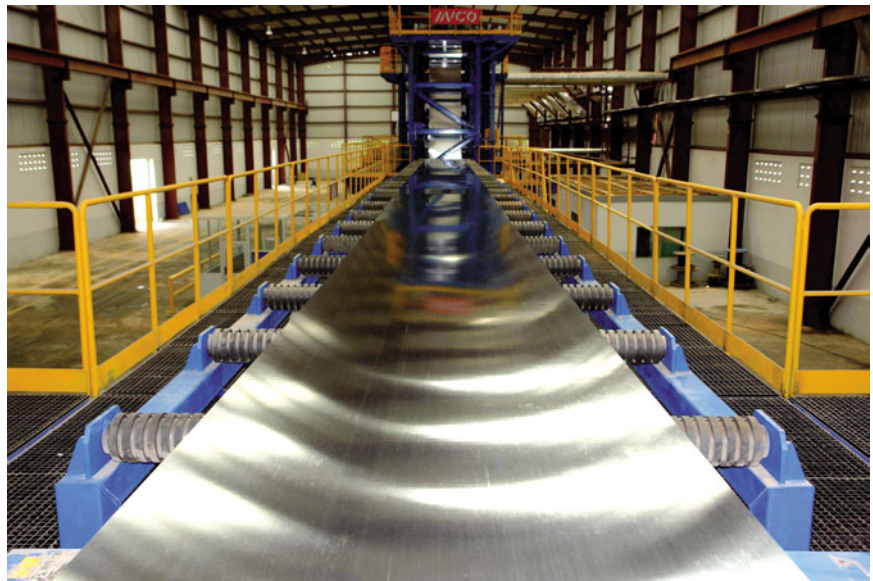
Рис. 2. Выходной участок линии нанесения покрытий на полосу в рулонах
