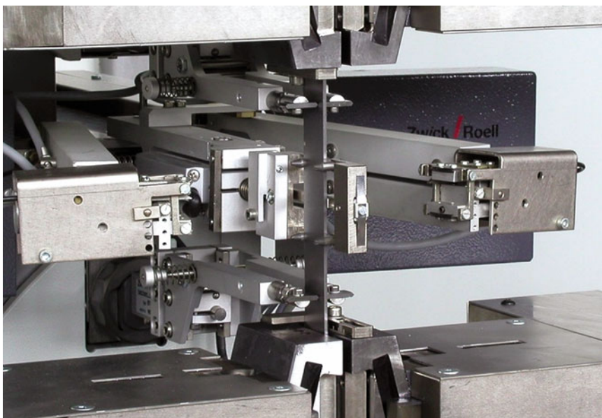
Рис. 2. Сочетание полностью автоматизированного экстензометра с контактными рычагами и сдвоенного экстензометра, усредняющего осевые и поперечные напряжения
