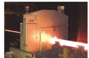
Система измерения толщины стенки труб Tube measurement
