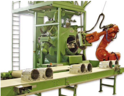
Высокоэффективный обрабатывающий центр для удаления грата и чистовой обработки картеров сцепления
