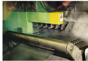
Система измерения толщины холоднокатаной полосы Thickness measuring cold strip
