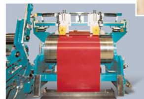
Радиометрическая система измерения толщины покрытия Coating measurement radiometrical
