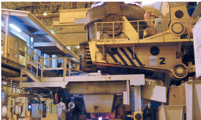
Новая машина непрерывного литья слэбов бразильской металлургической фирмы Gerdau Acominas
