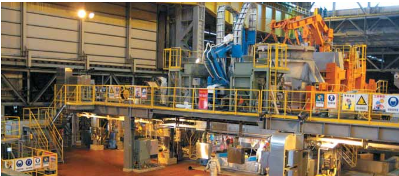
Рис. 1. Разливочная площадка новой трехручьевой машины непрерывного литья блюмов
