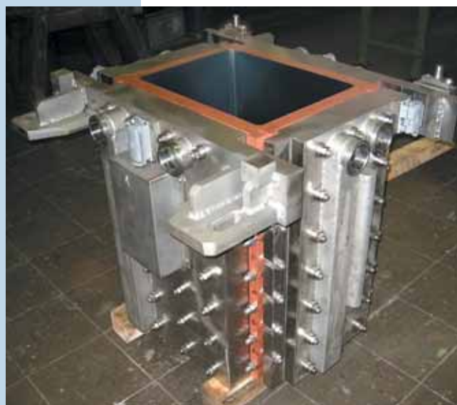
Рис. 2. Пластинчатый кристаллизатор, обеспечивающий лучшее перемешивание стали
