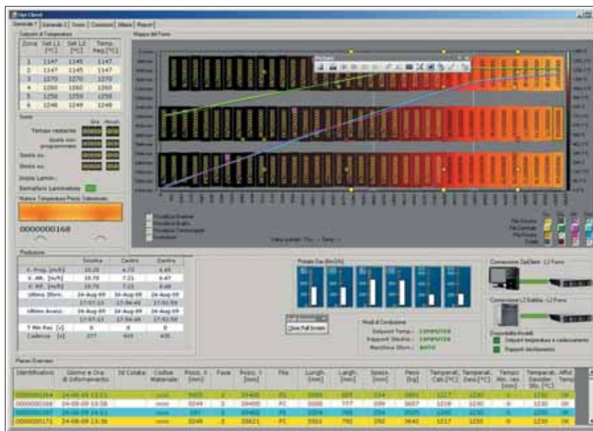
Рис. 6. Температурная карта слябов, находящихся в печи, на интерфейсе «человек — машина»
