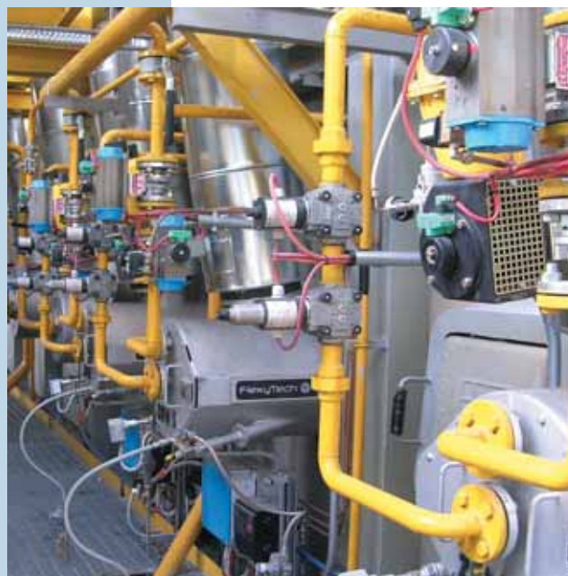
Рис. 2. Горелки FlexyTech® серии TSX в нагревательной печи фирмы Metinvest Trametal
