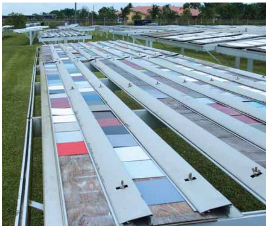
Рис. 1. Площадка для испытаний в условиях стабильной освещенности и влажности, Флорида, США
