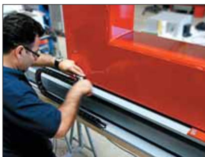
Компактная система CALIX может быть легко установлена в рабочее положение для сканирования
