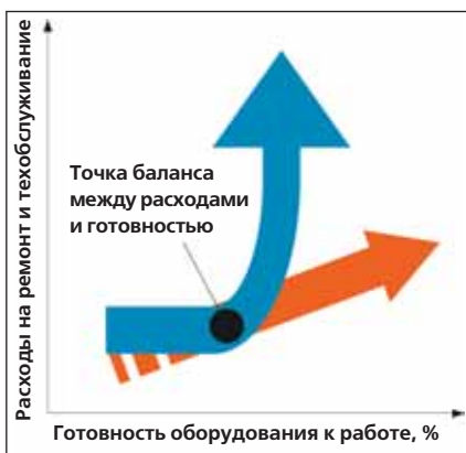
Рис. 3. Точка баланса между затратами на ремонт/техническое обслуживание и готовностью оборудования к работе
