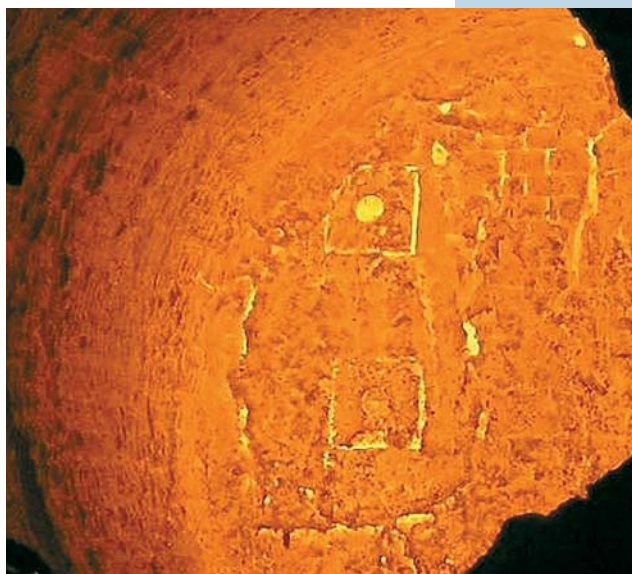
Рис. 1. Одна из двух продувочных пробок в ковше не работает должным образом
