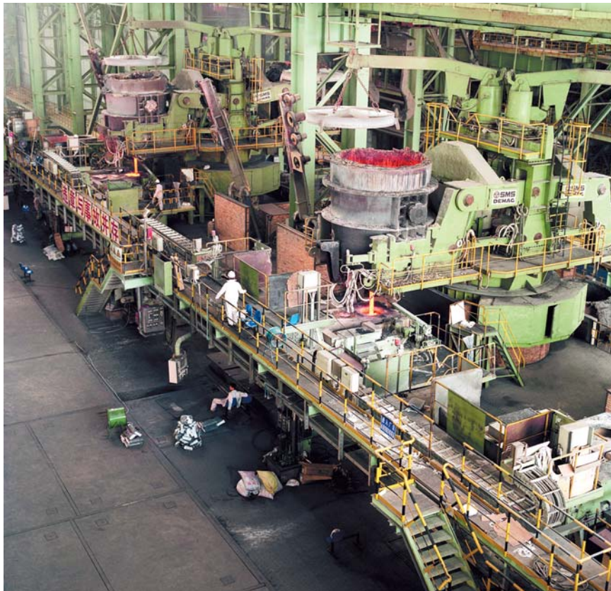
Рис. 1. Разливочный пролет двух одноручевых МНЛЗ агрегата CSP® на заводе компании Masteel
