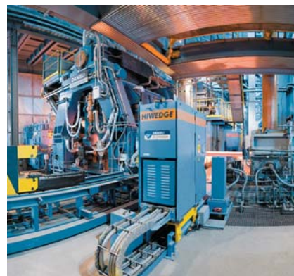
Рис. 5. Лазерная оптическая система для измерения кромок горячих непрерывнолитых слябов
