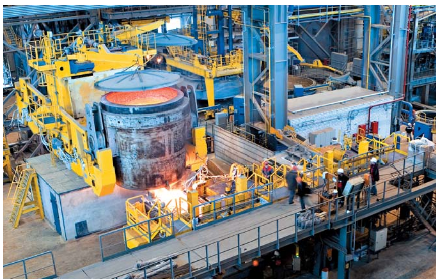
Рис. 2. Машина непрерывного литья тонких слябов фирмы Danieli, позволяющая разливать сталь марки API X70 для арктического применения
