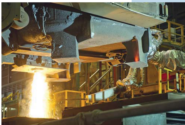
Рис. 9. Система LiquiRob на МНЛЗ № 5 (продувка кислородом)
