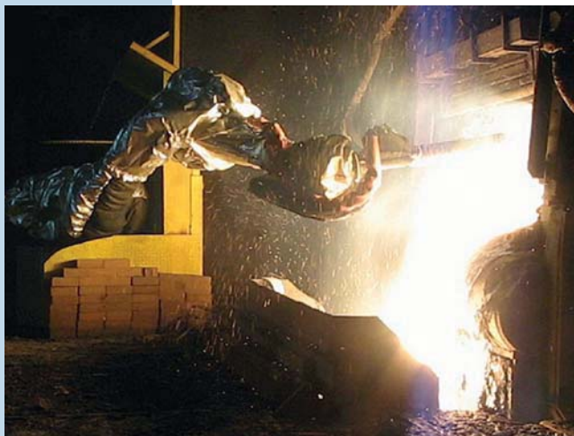
Рис. 6. Измерения содержания кислорода во время плавки в электродуговой печи роботами LiquiRob
