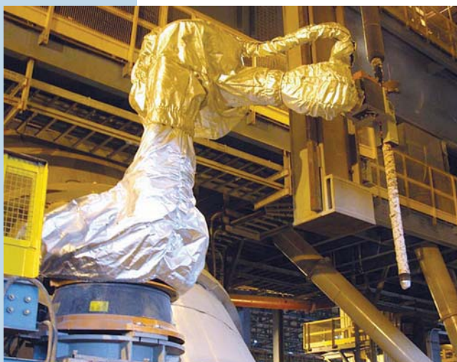
Рис. 7. Отделение втулки с пробой от зонда системой LiquiRob
