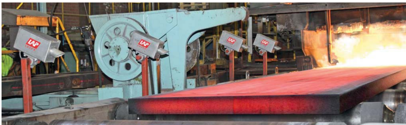
Рис. 1. Датчики, установленные на отводящем рольганге слябовой МНЛЗ
